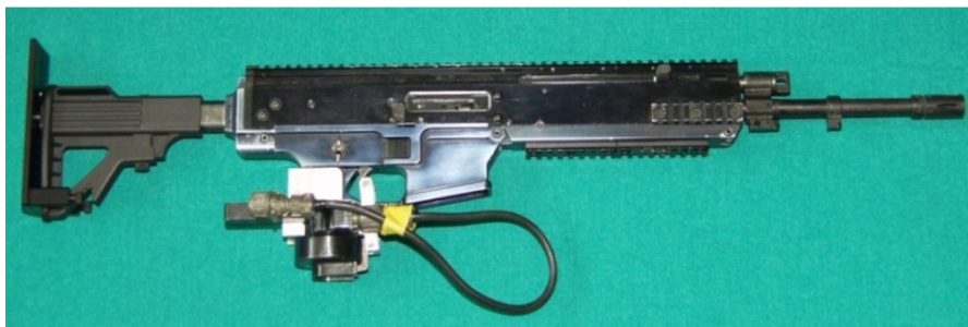
Fot. 1. Karabinek MSBS-5,56 K-01 w układzie klasycznym, przygotowany do zamocowania na stanowisku badawczym
