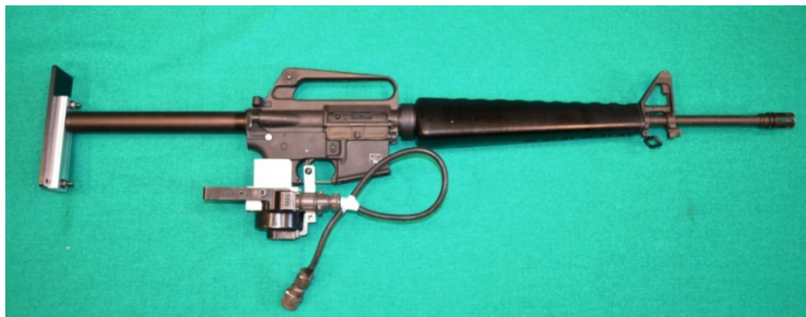
Fot. 4. Karabinek M16A1, przygotowany do zamocowania na stanowisku badawczym
