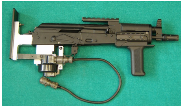
Fot. 3. Subkarabinek wz. 1996 „Mini Beryl” przygotowany do zamocowania na stanowisku badawczym
