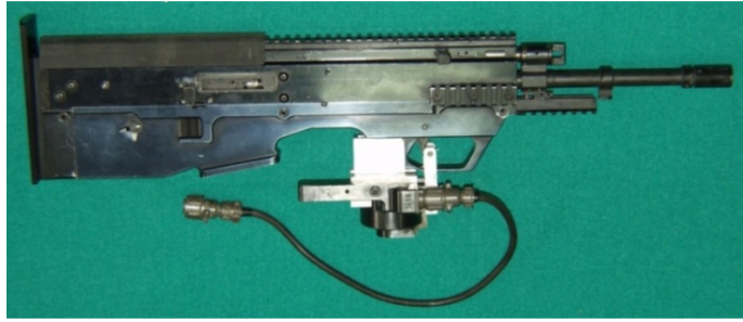
Fot. 2. Karabinek B-01 MSBS-5,56 w układzie bezkolbowym, przygotowany do zamocowania na stanowisku badawczym
