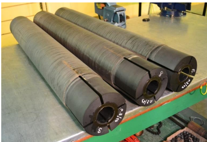
Rys. 3. Ładunki napędowe z paliwa homogenicznego o zoptymalizowanej konfiguracji technologicznej
