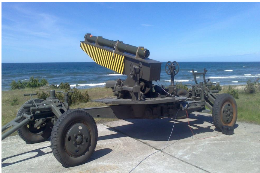
Rys. 10. Rakieta dwustopniowa w wyrzutni zamontowana na stendzie startowym
