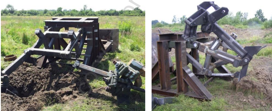
Rys. 8. Widok trań po badaniach: po pierwszym wybuchu (z lewej) i po drugim wybuchu (z prawej)
