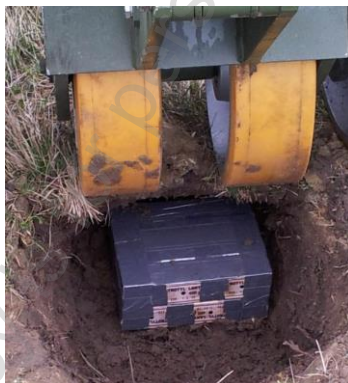
Rys. 6. Ładunek wybuchowy podłożony pod zestaw kołowy trału
