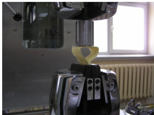
Rys. 4. Próbkę zamocowaną w uchwytach maszyny wytrzymałościowej
