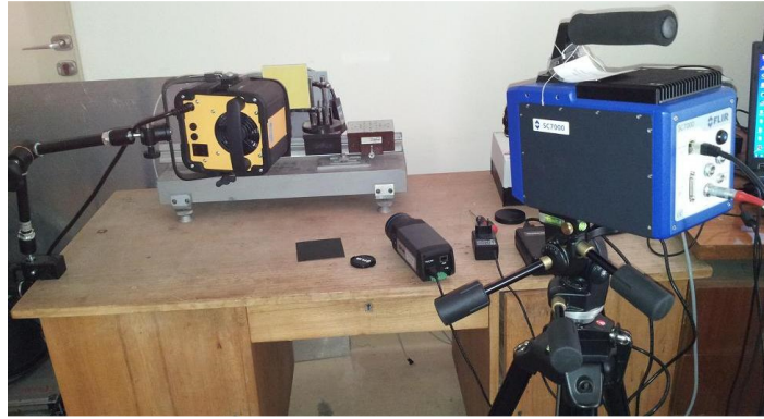
Fot. 1. Stanowisko do badań aktywności cieplnej metodą odbiciową: a) źródło stymulacji cieplnej – lampa, b) próbka badawcza – kompozyt aramidowy, c) urządzenie do rejestracji temperatury – kamera IR
