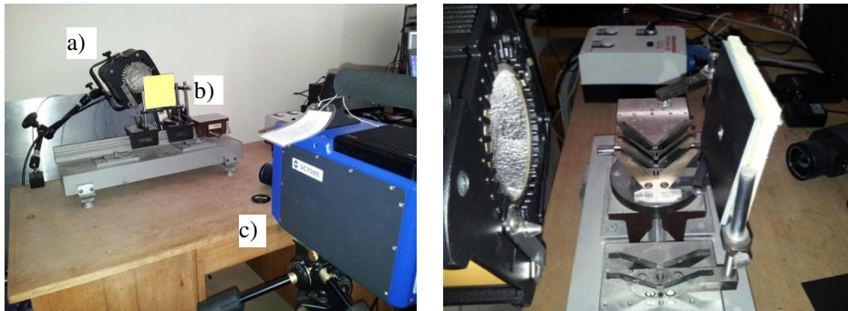
Fot. 2. Stanowisko do badań dyfuzyjności cieplnej metodą transmisyjną: a) źródło stymulacji cieplnej – lampa, b) próbka badawcza – kompozyt aramidowy, c) urządzenie do rejestracji temperatury – kamera IR
