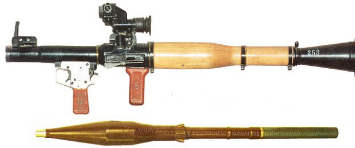
Rys. 1. Granatnik przeciwpancerny RPG-7 wraz z granatem PG-7 [1]
