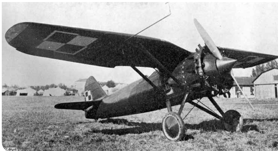
Fot. 5. Prototyp samolotu PZL P-7 podczas prób w 1931 roku. Pod skrzydłem dzida z dyszą pomiarową
