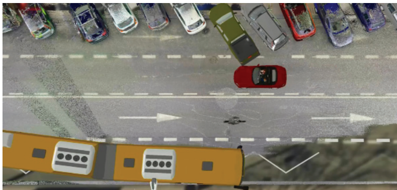
Rycina 2 Chmura punktów zarejestrowana skanerem 3D wykorzystana do wizualizacji miejsca zdarzenia drogowego w ramach symulacji ruchu pojazdu uwzględniającej zjawiska dynamiczne
